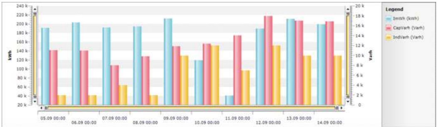
Bir kompanzasyon panosunun 10 günlük aktif ve reaktif enerji tüketim grafiği
