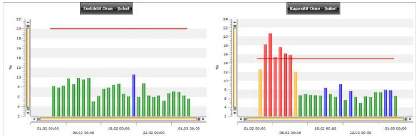
Bir kompanzasyon panosunun aylık indüktif ve kapasitif oran grafiği
